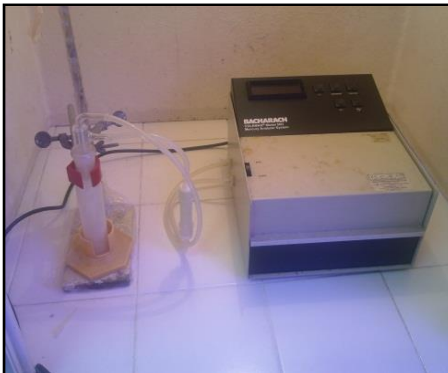
Figura 14. Sistema montado para a determinação do Hg total.
