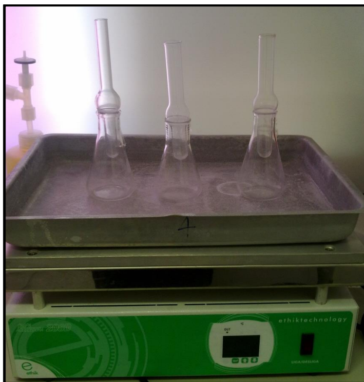
Figura 13. Imagem ilustrando o sistema fechado do tipo "cold finger".
